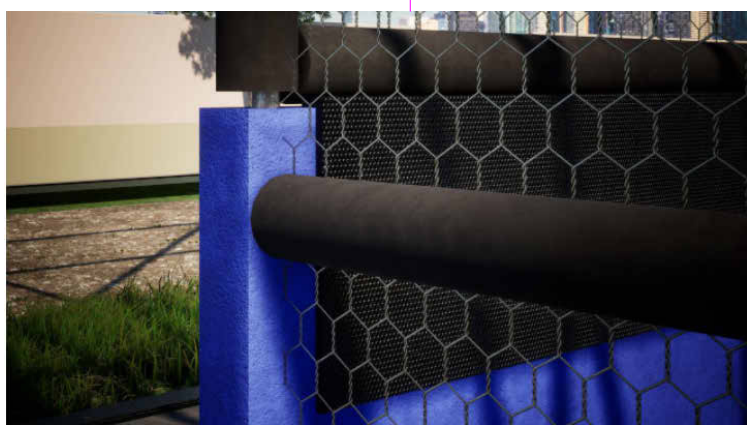
DET. H - Cantoneira e proteção da parede
